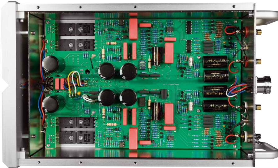
Das linke Drittel der Verstärkerplatine gehört zur Spannungsversorgung, der Rest ist Signalverarbeitung
